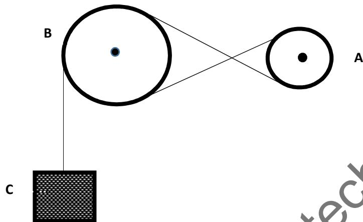
**1/ Indiquer sur le schéma dans quel sens la roue A doit-elle tourner pour que la charge C monte. 0,5pt**
